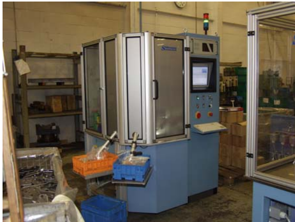
Mess-, Prüf- und Sortierautomat für Drehteile
