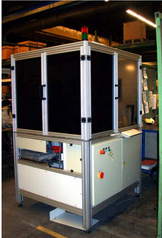
Automatisches Inspektionssystem für Kleinteile mit einer meist flachen Bauweise
