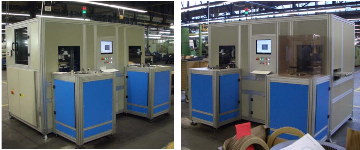
Automatisches Mess-, Prüf- und Sortiersystem mit Stapelmagazin für Werkstück- Eintrag und Austrag
